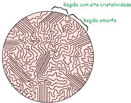
Figura 6 - Configuração de uma matriz termoplástica semicristalina.
