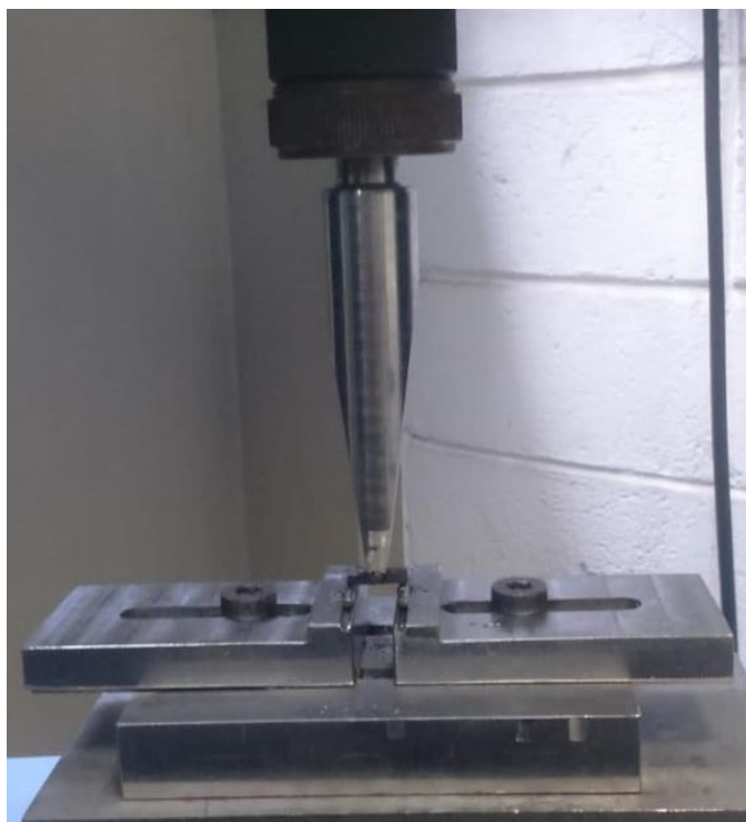
Figura 25 - Momento de realização dos ensaios de ILSS.
