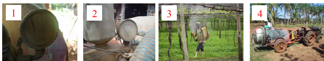
Figura 35. Manômetros danificados (1) e (2); pulverização manual (3); pulverização mecanizada (4) em Jales (SP).
