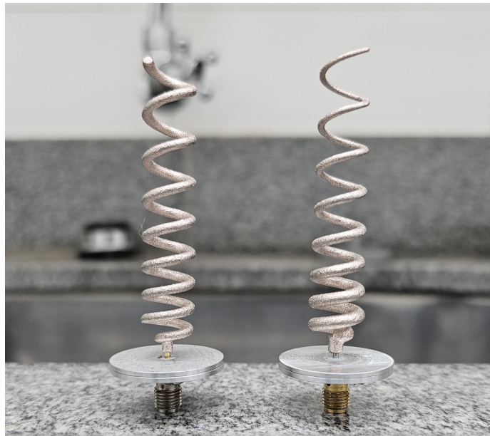
Figura 21 — Antenas Produzidas por SLS Devidamente Montadas.
