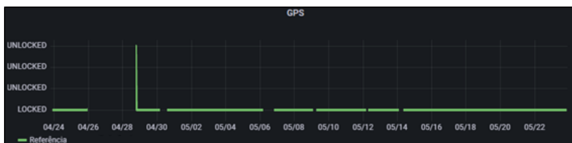
Figura 50 - Monitoração do sinal de referência GPS no transmissor durante 1 mês.
