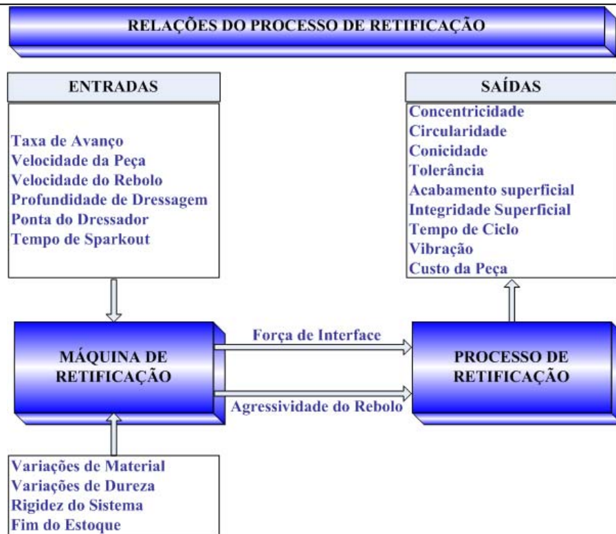
Figura 4 Variáveis de entrada e saída para máquinas e processos de retificação (Adaptado de KING & HAHN, 1986).
