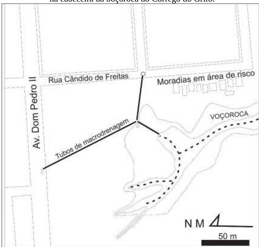
Figura 65 – Galerias do sistema de macrodrenagem urbana na cabeceira da boçoroca do Córrego do Grito.
