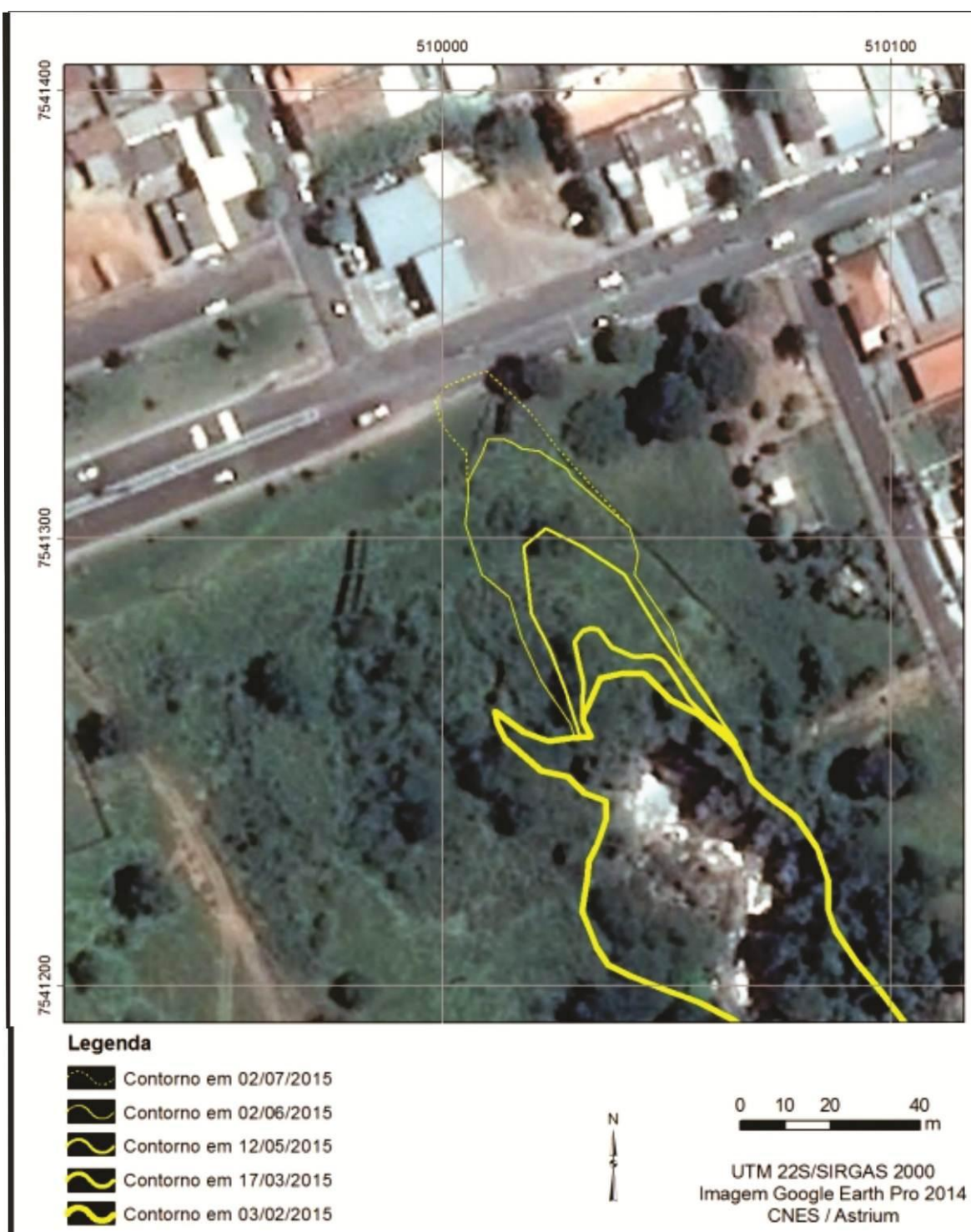
Figura 68 – Croqui do monitoramento da erosão remontante
