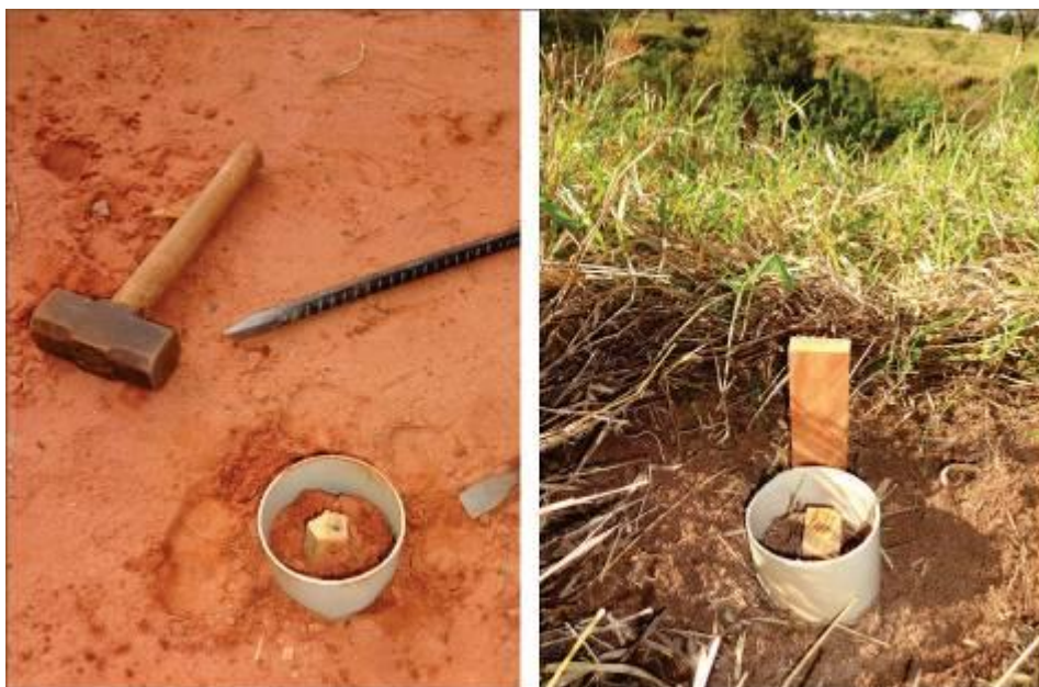
Figura 04a e 04b – Marcos de rastreio dos receptores GNSS.
