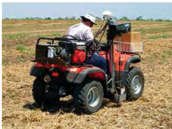
Figura 5 – Equipamento para amostragem de solo automatizada. (Fonte: www.tecnoparts.agr.br/servicos/amostragem-de-solo )
