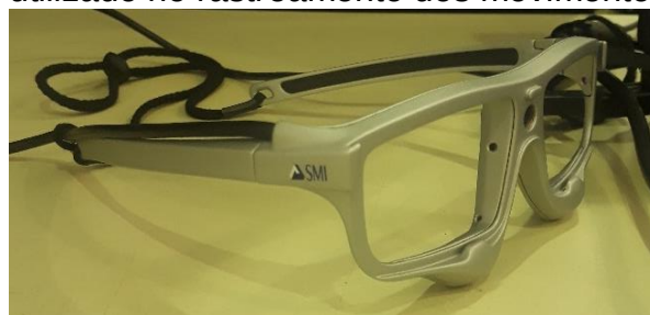
Figura 2. Foto dos óculos do sistema Eye Tracking Glasses – ETG 2.0 – SMI, dispositivo utilizado no rastreamento dos movimentos dos olhos.
