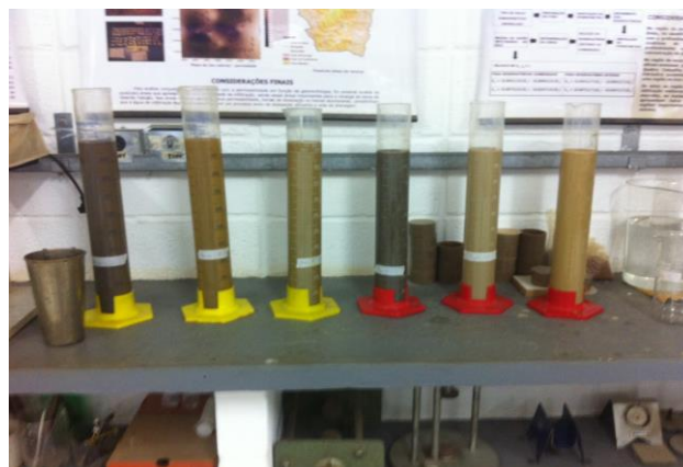
Figura 6. Granulometria por sedimentação.
