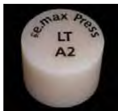
Figura 3 – Pastilha de cerâmica IPS E.max Press (dissilicato de lítio).
