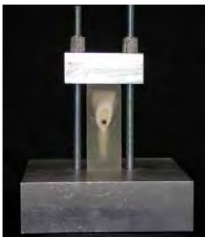
Figura 9 – Base metálica para posicionamento dos corpos-de-prova para o ensaio.
