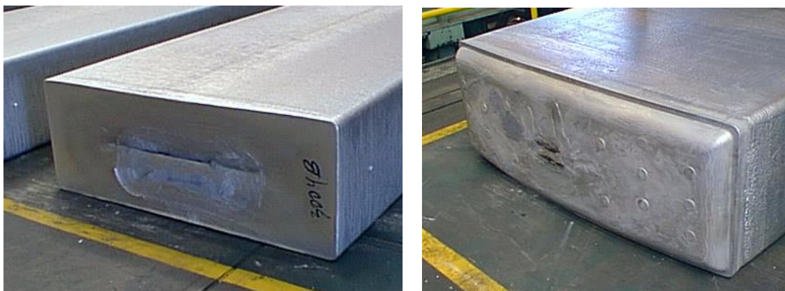
Figura 42 – Imagem demonstrando aspecto ideal das extremidades de uma placa
