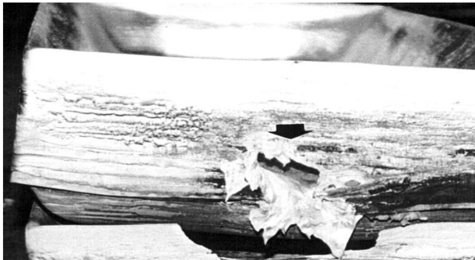
Figura 50 – Exemplo de falta de água durante um vazamento
