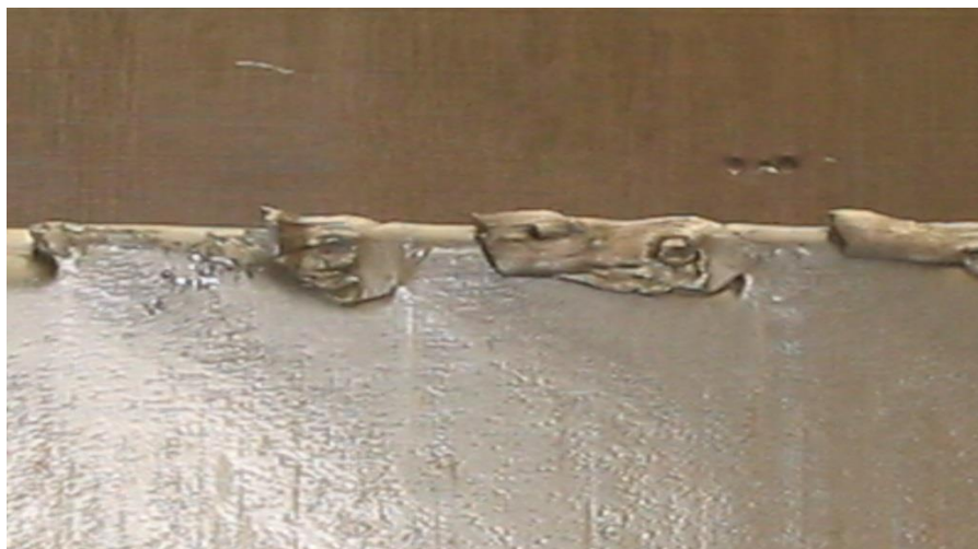
Figura 49 – Exemplo de sangria nos cantos da placa
