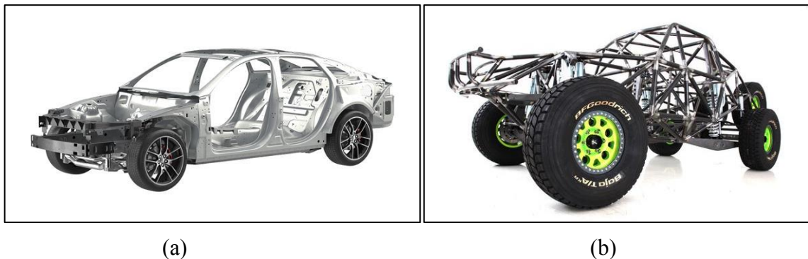
Figura 2 – (a) Chassi de um carro popular; (b) Chassi esportivo tubular.
