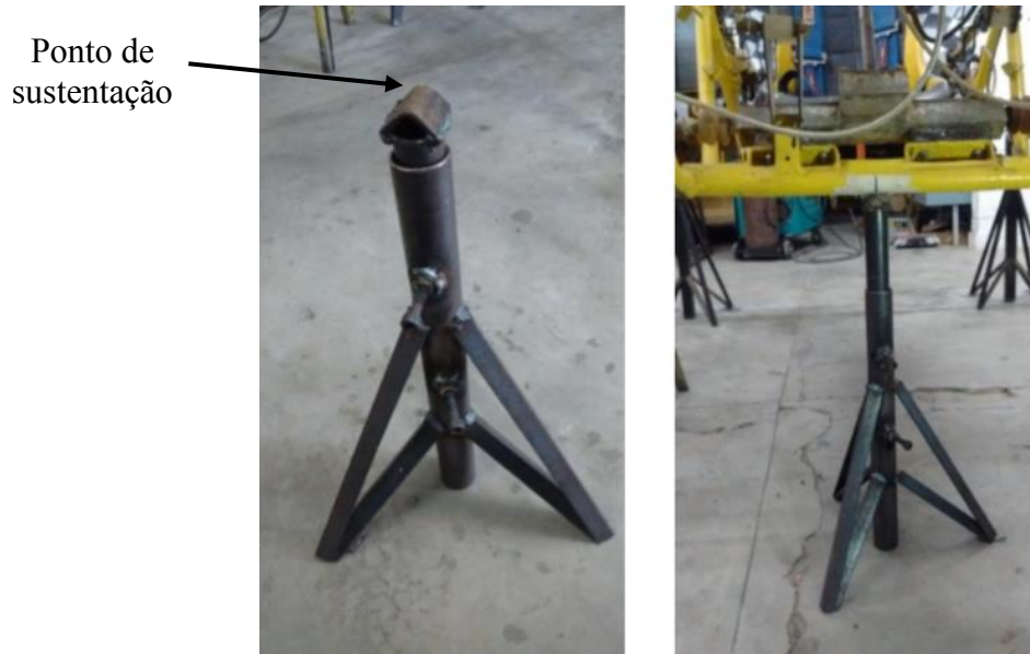
Figura 10 – Fixação e sustentação da parte dianteira.
