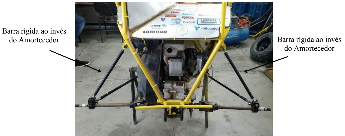
Figura 7 – Barras rígidas substituindo os amortecedores.
