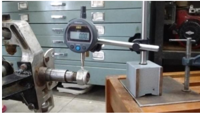
Figura 12 – Posicionamento do relógio comparador.
