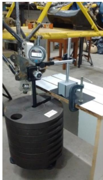
Figura 13 – Aplicação das anilhas e medição das deformações.
