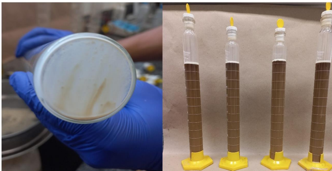
Figura 1. Sedimentação e separação de fases de inseticida associado a adjuvantes.
