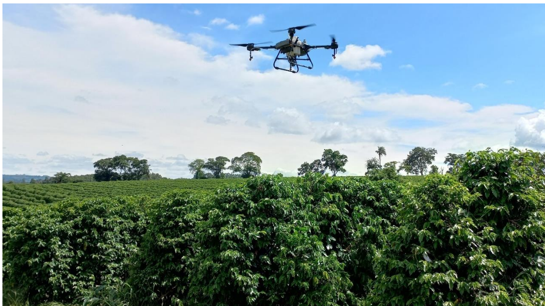
Figura 3. ARP multi-rotor utilizado em experimento de pulverização para controle da broca-do-café. Jeriquara/SP, 2022.
