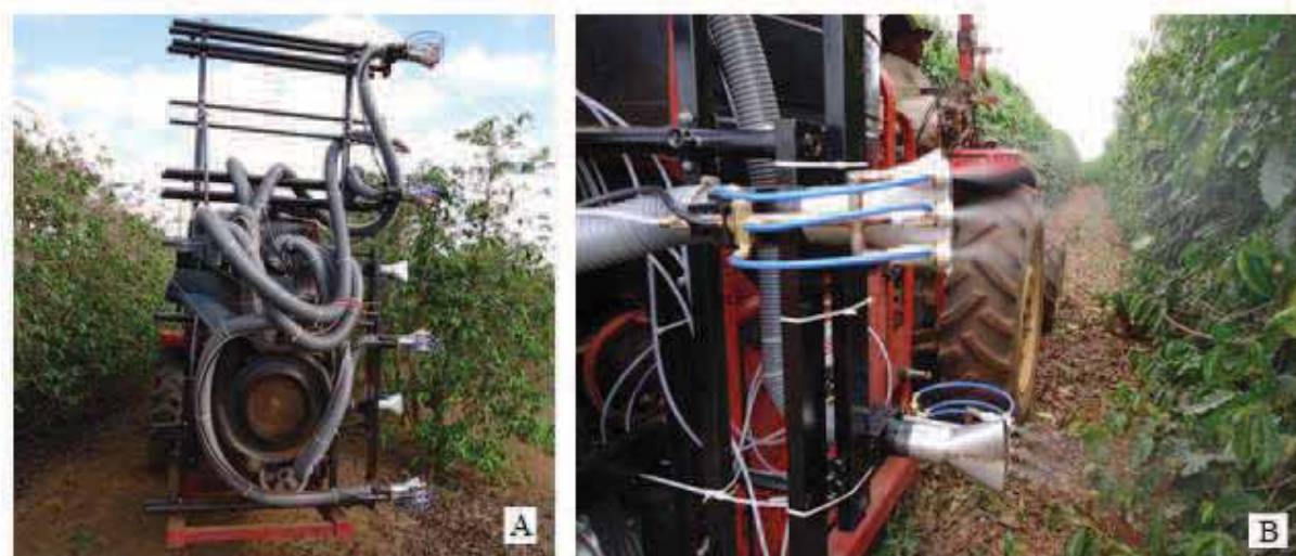
Figura 4. Protótipo de um pulverizador para volume reduzido: visão geral (A) e detalhe dos bocais “efervescentes” (B).
