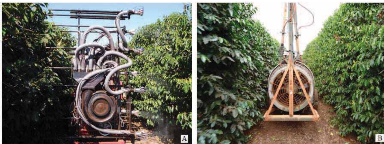
Figura 5. Pulverizadores avaliados no experimento 2: protótipo de volume reduzido versão 2013 (A) e convencional Arbus 2000 (B).
