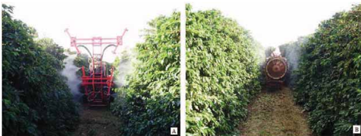
Figura 3. Pulverizadores avaliados no experimento 1: protótipo de volume reduzido versão 2012 (A) e convencional Arbus 400 (B).
