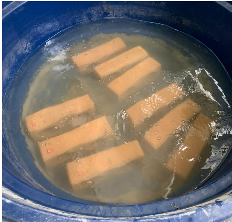
Figura 16 - Tijolos contendo diferentes proporções de carepa de laminação imersos em água por 24 horas.
