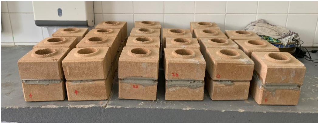
Figura 13 - Tijolos contendo 15%; 25% e 0% de carepa (da esquerda para a direita), cortados ao meio e sobrepostos com pasta de cimento.
