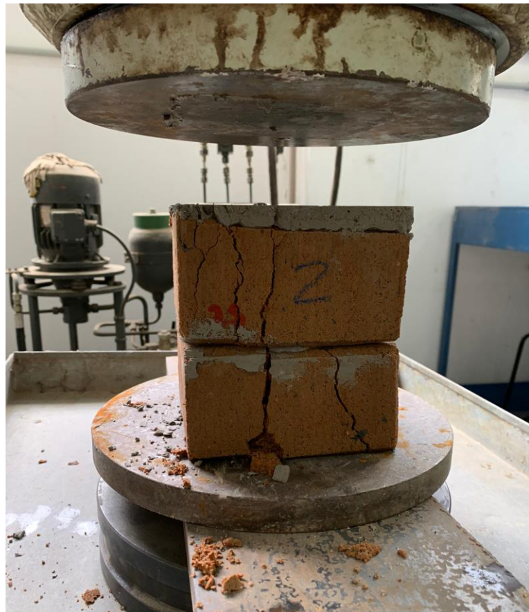
Figura 15 - Corpo de prova (CP25-2) contendo 25% de carepa de laminação, rompido.
