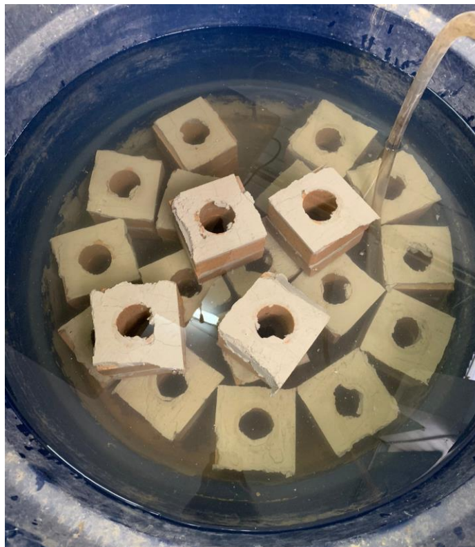
Figura 14 - Corpos de prova imersos em água pré-ensaio de resistência à compressão.
