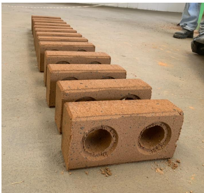
Figura 12 - Tijolos de solo-cimento com substituição de cimento Portland por 15% de carepa de laminação.
