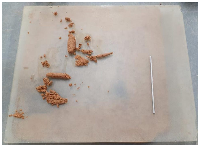
Figura 7 - Determinação do limite de plasticidade do solo.
