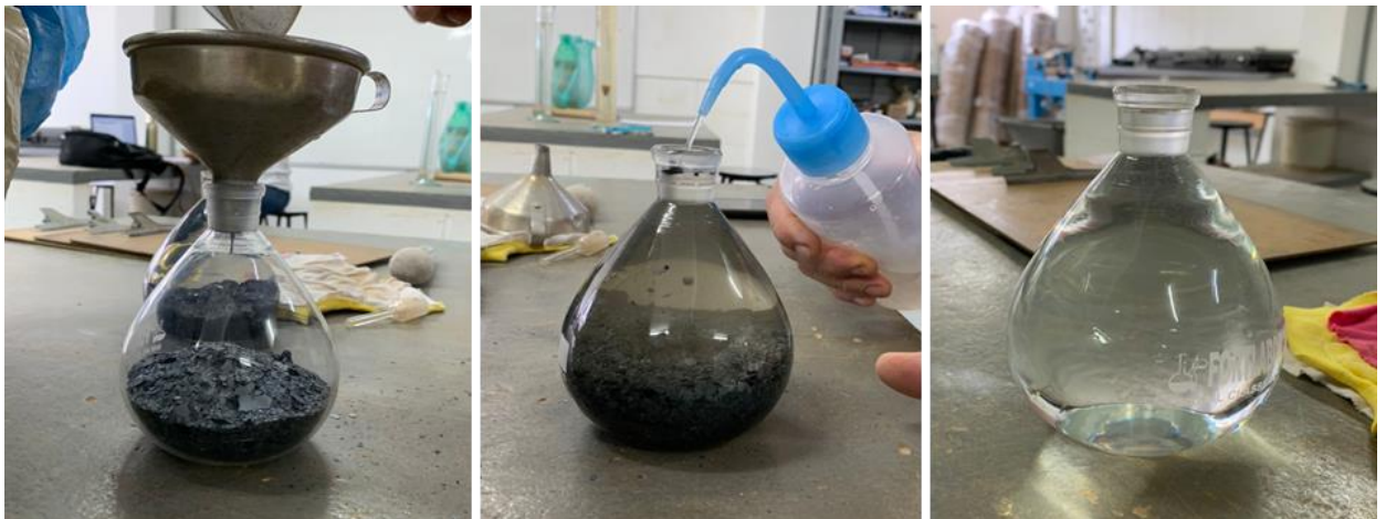
Figura 10 - Picnômetro com carepa, com carepa e água e apenas com água, respectivamente.
