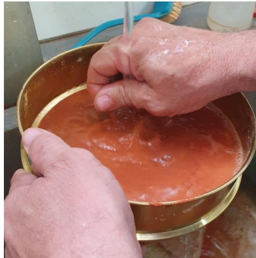
Figura 6 - Análise granulométrica do solo do município de Canas (SP) por peneiramento úmido.
