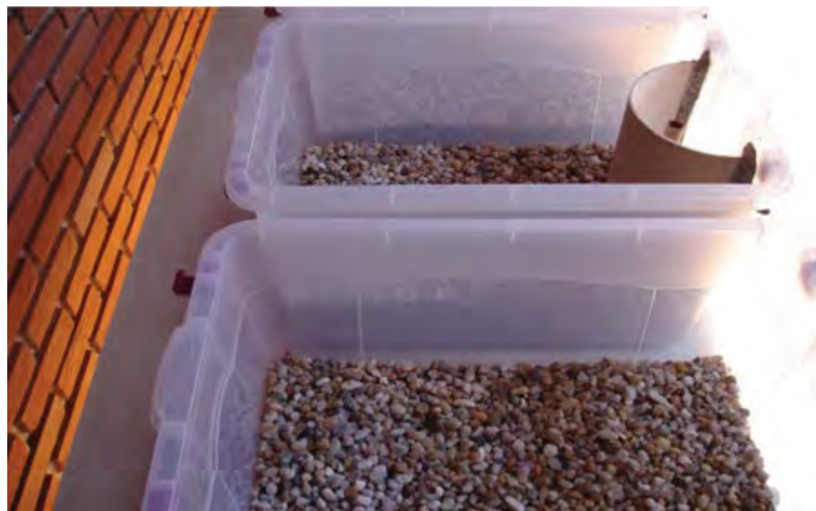
Figura 11. Detalhe dos CWSs tipo ascendente/descendente, com a 2ª camada de 4,5 cm de seixo rolado (12,8 a 25 mm).
