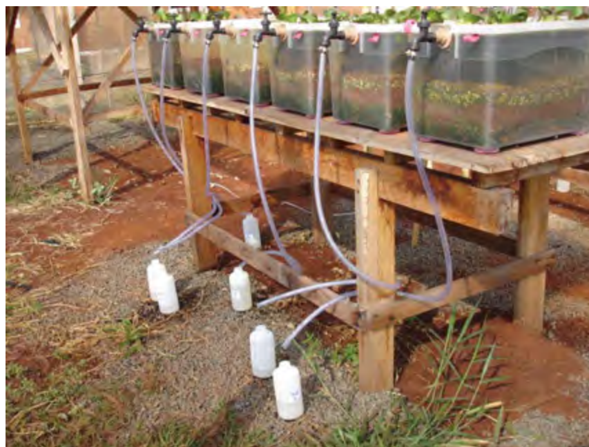
Figura 27. Aspectos das coletas do efluente nos protótipos ascendentes, com destaque para as garrafas de polietileno usadas para coleta.
