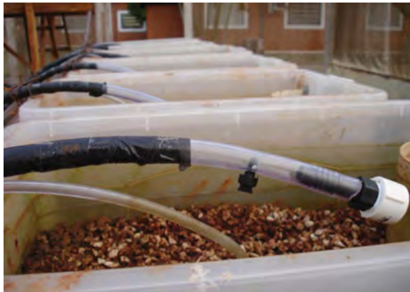
Figura 16. Detalhe do gotejador usado nos protótipos tipo descendente, localizado próximo da extremidade da mangueira.
