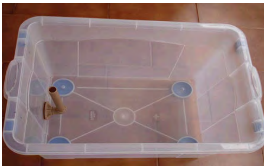
Figura 6. Detalhe da montagem do sistema de sifão nos CWSs do tipo ascendente/descendente.
