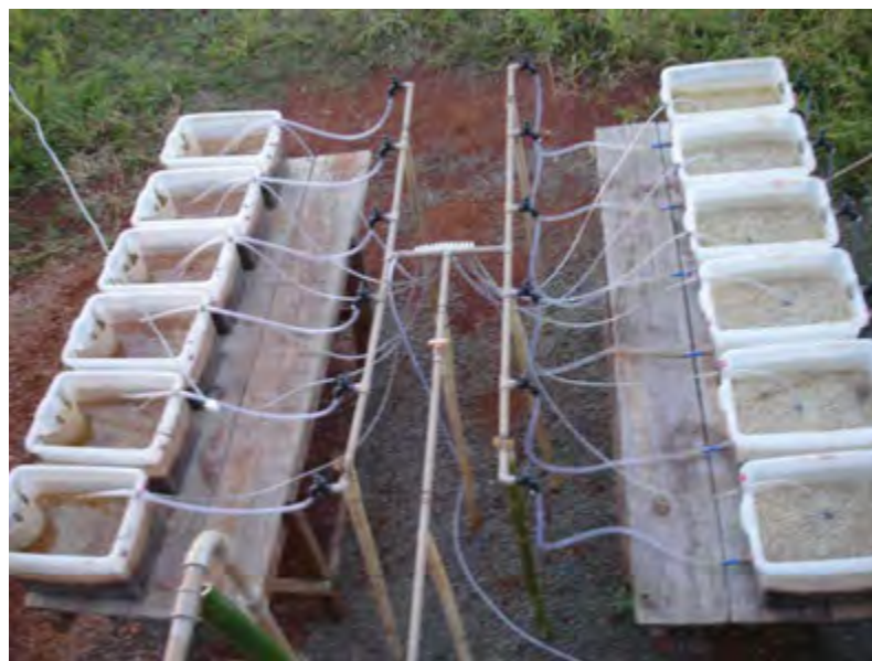
Figura 22. Vista aérea da distribuição do efluente avícola nos 12 reservatórios de tratamento
