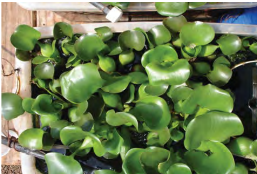
Figura 5. Detalhe do reservatório tipo descendente contendo efluente, solo filtrante e macrófitas.
