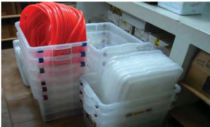
Figura 3. Caixas plásticas de 55 litros e mangueira de jardim, utilizadas na montagem dos CWSs.
