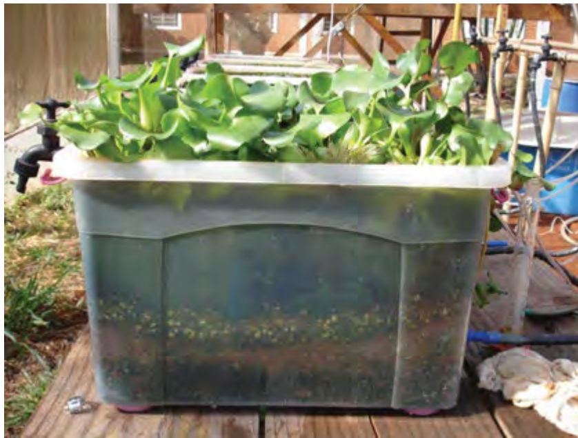
Figura 62. Detalhe de um reservatório contendo o solo filtrante e a macrófita Eichhornia crassipes , após 30 dias de experimento.
