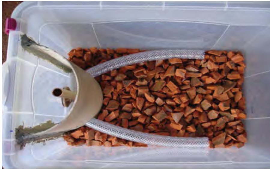
Figura 9. Detalhe da 1ª camada formada por 3 cm de caco de telha – CWS tipo descendente.
