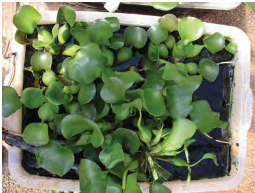
Figura 64. Detalhe de um reservatório contendo o solo filtrante e a macrófita Eichhornia crassipes , após 77 dias de experimento.
