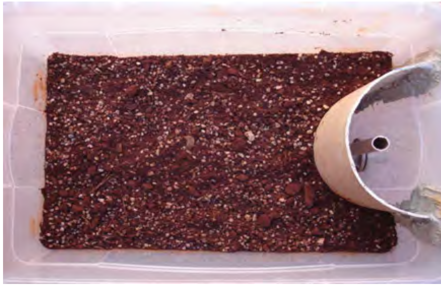
Figura 12. Detalhe da 3ª camada composta da mistura de 6,0 cm de solo e seixo rolado (3,2 a 8,6 mm) no CWS tipo ascendente/descendente.
