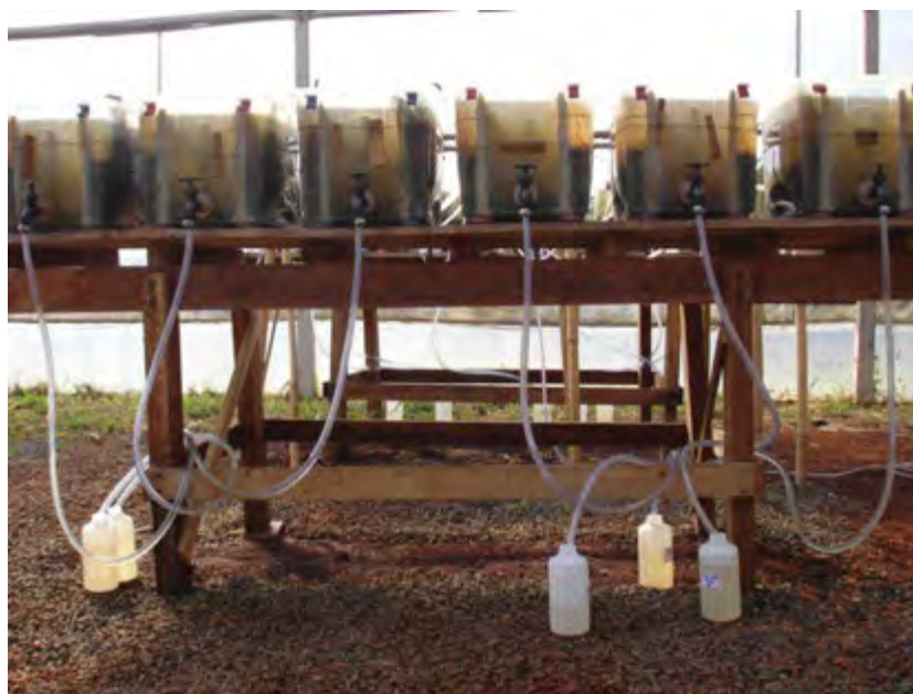
Figura 26. Aspectos das coletas do efluente nos protótipos descendentes, com destaque para as garrafas de polietileno usadas para coletas.
