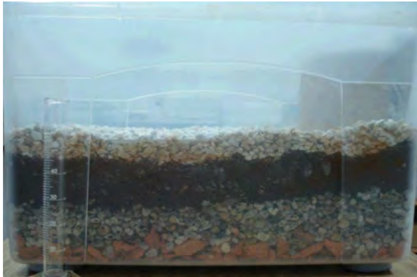
Figura 14. Detalhe das 4 camadas que compõe os CWSs
