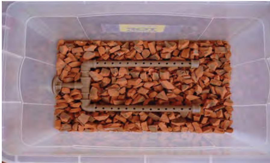
Figura 10. Detalhe da 1ª camada constituída por 3 cm de caco de telha – CWS tipo ascendente.
