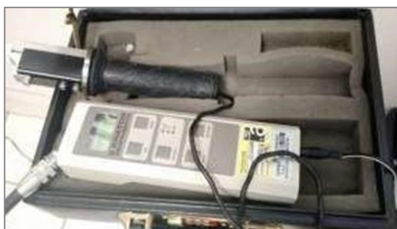
FIGURA 2 – Dinamômetro Digital IDDK da marca Kratos
