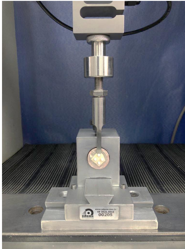
Figura 11 – Realização do teste de cisalhamento na máquina EMIC
