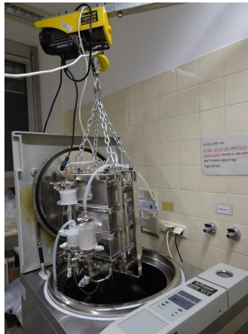
Figura 3. Detalhe do processo de esterilização do Laboratory Fermenter Prophyta L03® em autoclave de 160 L [Tuttnauer autoclave 5075EL - esterilizador a vapor, Holanda]
