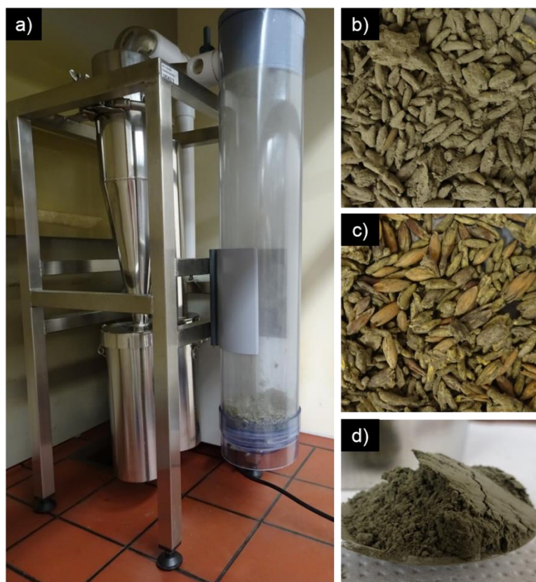
Figura 2. Sistema Mycoharvester®. Equipamento Mycoharvester®, versão 5b (a); substrato colonizado por Metarhizium anisopliae antes (b) e após a colheita (c); conídios puros de Metarhizium anisopliae (d).
