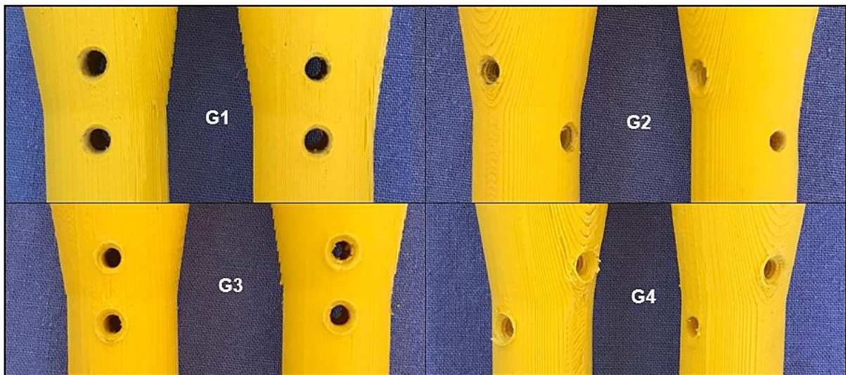
Figura 8. Imagens fotográficas dos corpos de prova dos quatro grupos G1 (hastes com parafusos roscados paralelos entre si), G2 (hastes com parafusos roscados ortogonais entre si), G3 (hastes com bolt paralelos entre si) e o G4 (hastes com bolt ortogonais entre si), após teste de torção (não destrutível). Observe que em todos eles as bordas dos orifícios apresentaram danos macroscópicos pelo momento de torção do corpo do parafuso pressionando a borda do corpo de prova.
