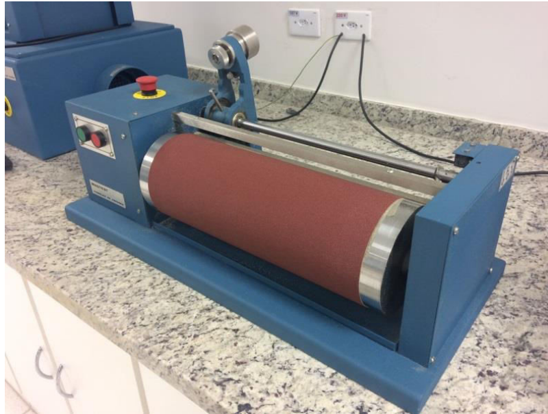
Figura 8 - Abrasímetro utilizado nos ensaios de resistência à abrasão.
