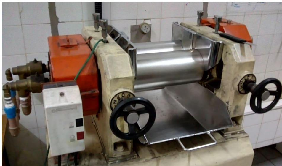
Figura 6 - Misturador aberto utilizado para preparação das misturas.
