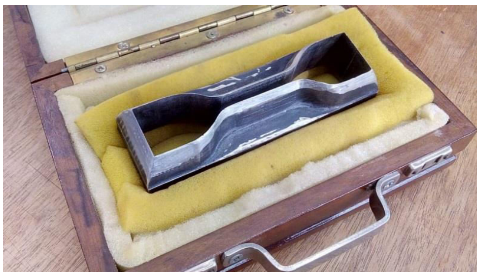
Figura 7 - Faca para corte dos compósitos em formato gravata tipo C.
