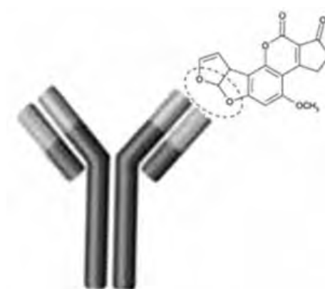
Figura 43. Esquema da interação do anticorpo anti-aflatoxina B 1 com uma molécula de aflatoxina B 1 .
