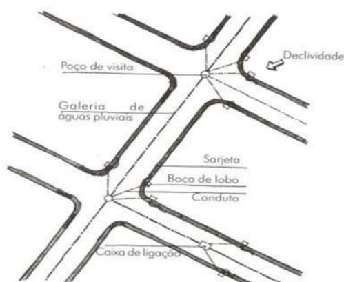
Figura 2 – Sistema pluvial e drenagem pluvial convencional
