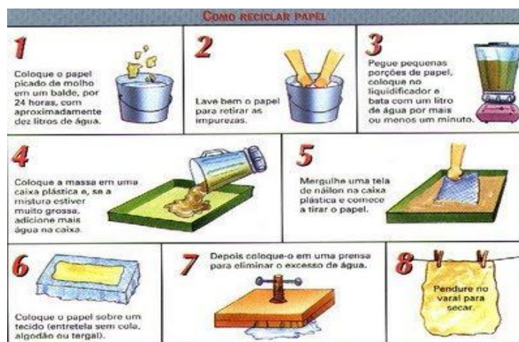
Figura 3 - Reciclagem de Papel Artesanal – Processo
