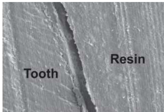
Figura 2. Imagem da interface entre dente e o material resinoso. Nessa figura pode-se notar a presença de uma fenda causada pela falha de adesão (GUIMARÃES et al., 2018).
