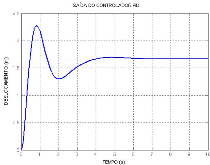
Figura 4.8 – Saída do sistema controlado com um PID.
