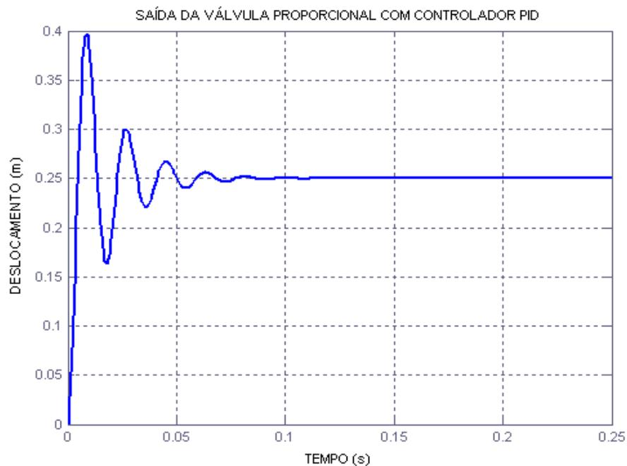
Figura 4.10 – Gráfico da abertura da válvula proporcional com o controlador PID.
