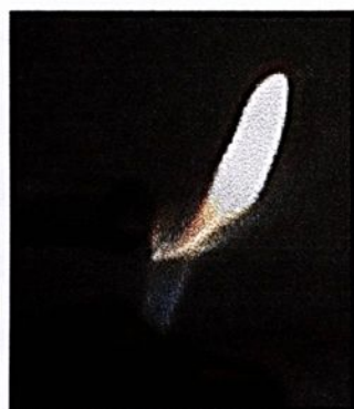
FIGURA 3.22 – Teste de queima – biogás com água de lavagem
