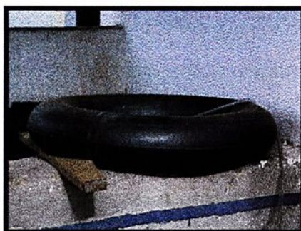
FIGURA 3.12 - Câmara com biogás
