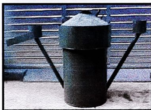
FIGURA 3.3 - Biodigestor 200 litros - Completo
