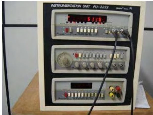
Figura 6-13 - Freqüencímetro utilizado para a contagem automática das franjas de interferência.
