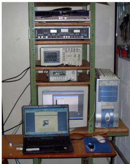
Figura 6-12 - Foto da instrumentação eletrônica utilizada. Nela, podem ser visualizados o osciloscópio digital, o gerador de funções e os computadores usados na aquisição dos dados.
