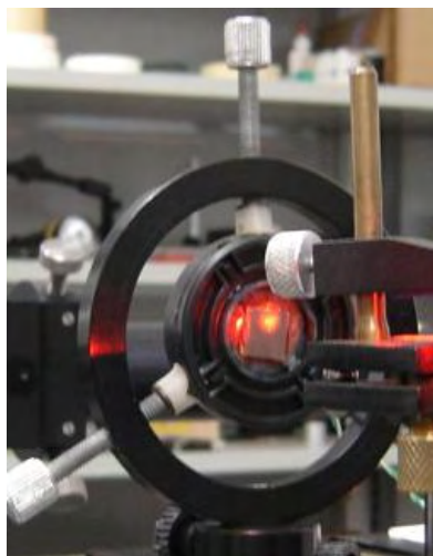
Figura 6-2 - Espelho colado ao tweeter piezelétrico.
