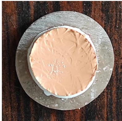
Imagem 4 - Anel nítido de cimento ao redor do disco de GP
