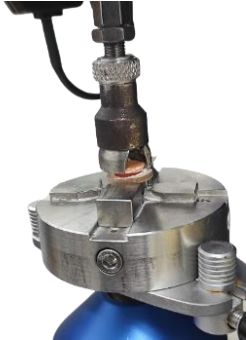
Imagem 8 - Dispositivo para teste de tração
