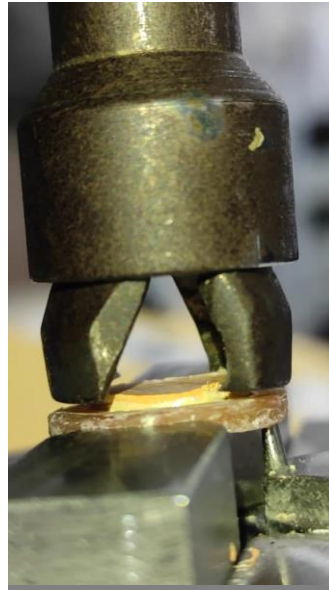
Imagem 7 - Dispositivo desenhado para o teste de tração
