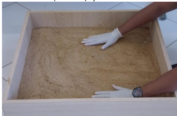
Figura 3: Caixa de areia, para auxiliar na sustentação das partes da peça colada.
