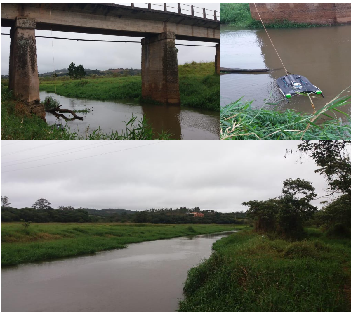
Figura 7 – Medição do fluxo de água no principal tributário, utilizando o ADCP
