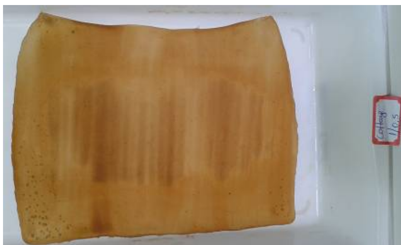
Figura 3.3.1 - Foto da BN coagulada com soro cottage após vinte e quatro horas na estufa a 60^\circ\text{C} .
