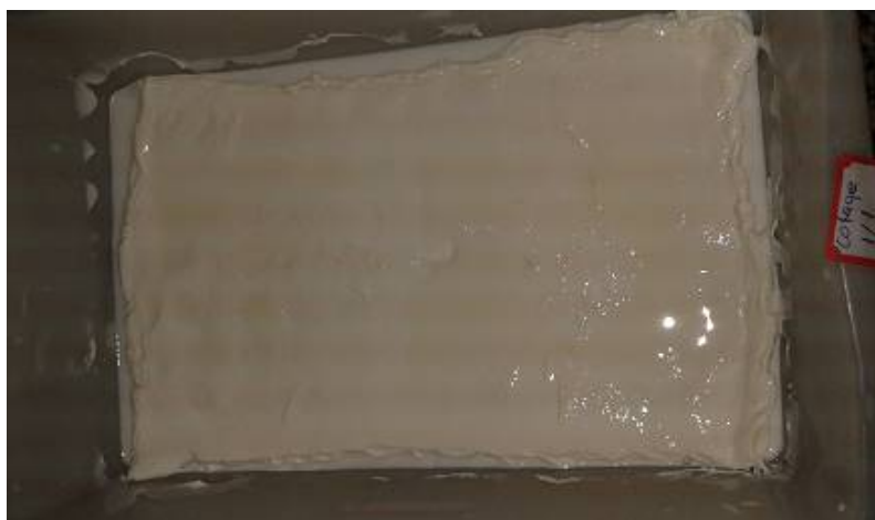
Figura 3.3 - Foto da Coagulação da BN em bandeja, utilizando como coagulante soro do queijo cottage.
