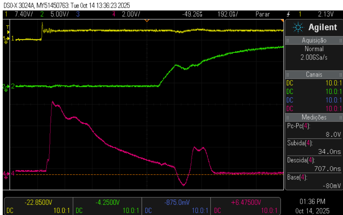
Figura 39 - Medição das tensões de pico a pico e de base e tempos de subida e descida da queda de tensão sobre o resistor de gate da chave AL1 em vermelho; tensão gate-source de BH1 em verde
