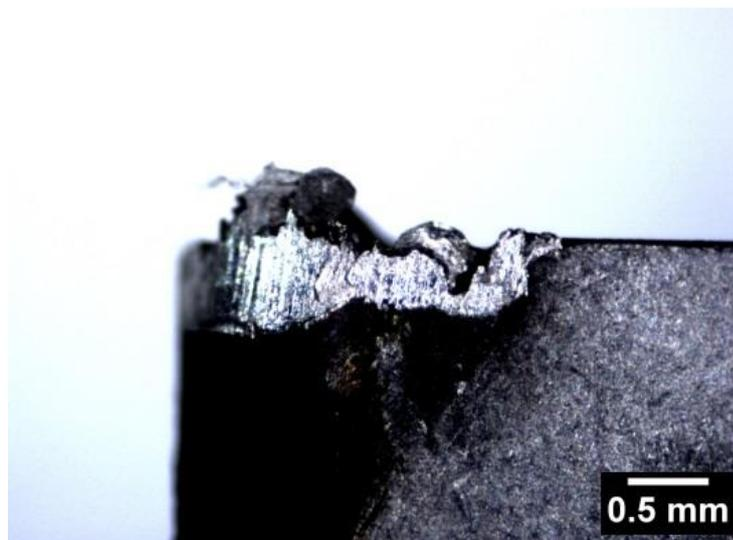
A presença de material aderido à ferramenta é explicada através da Figura 5.5 onde fica mais evidente com a imagem feita por EDS (Energy Dispersive Spectroscopy) da ferramenta. Analisando mais afundo a superfície desgastada por meio da Figura 5.5 é possível
