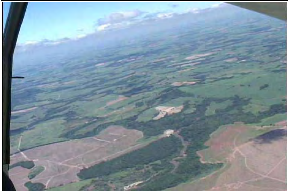
Figura 53 – Distrito de Assistência. Nota-se o contraste de texturas no relevo nas metades inferior e superior da imagem, identificando duas zonas de significado morfotectônico distintos, ressaltados pelas variações nos padrões de drenagem. Visada de NE para SW, altitude de 450 metros do solo..
