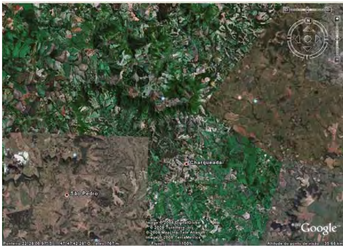
Figura 43 a – Padrões de drenagem mostrando forte controle estrutural de direção NW, lineamento.
