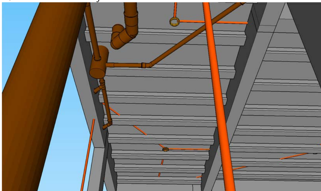
Figura 43 – Pontos de luz na laje
