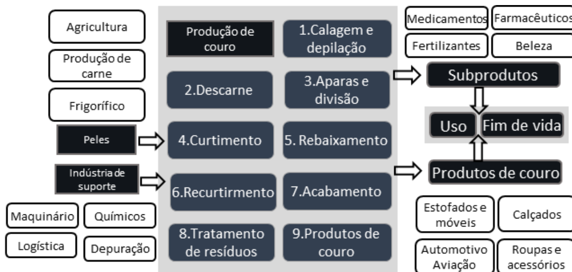
Figura 10 - Etapas da produção do couro bovino
