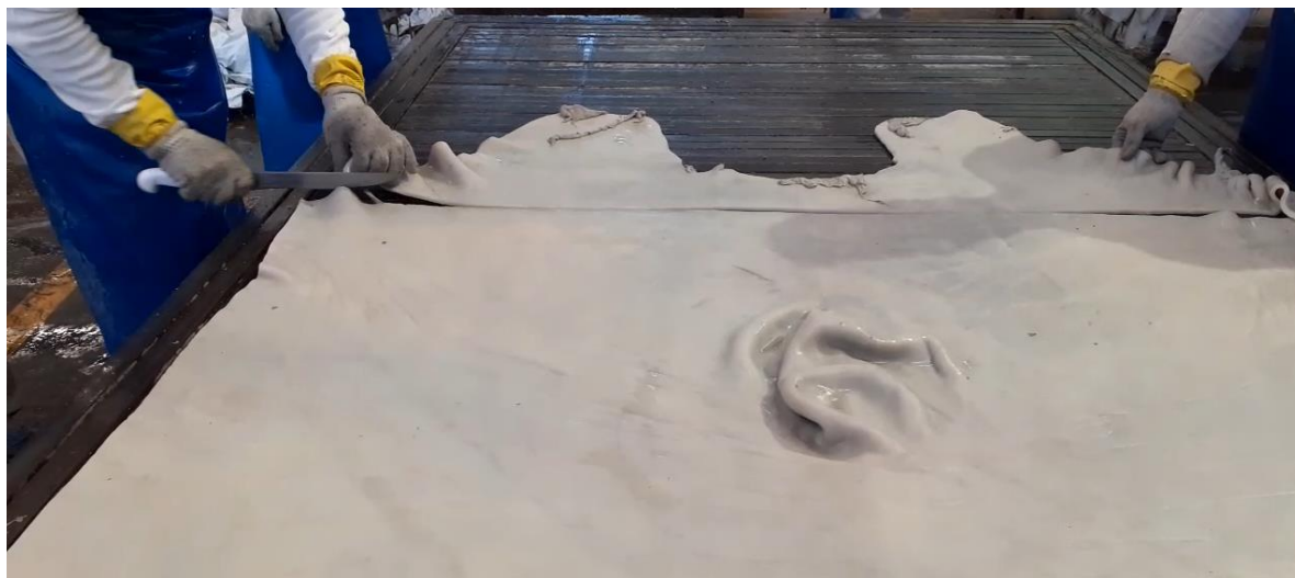
Figura 44 - Realização das aparas ainda na pele não curtida
