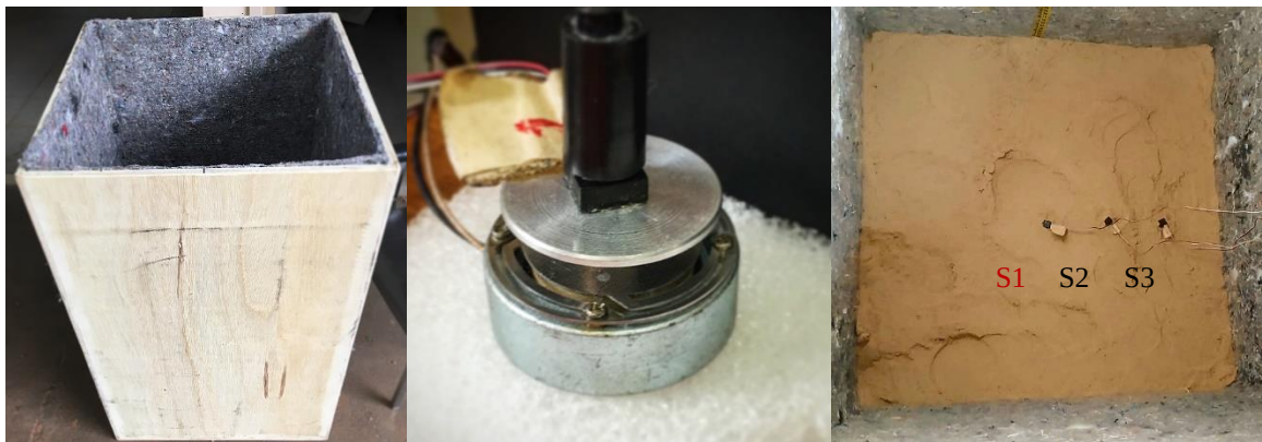
Figura 49 - a) Caixa do experimento. b) Transdutor com acelerômetro. c) Acelerômetros.
