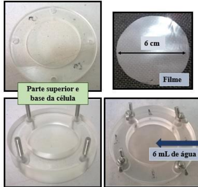
Figura 7 – Representação do filme e célula utilizados para as medidas de permeabilidade ao vapor de água
