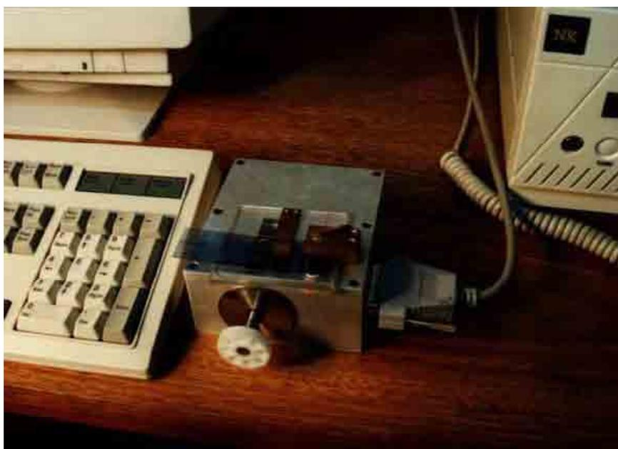
Figura 3.8 – Microdensitômetro.
