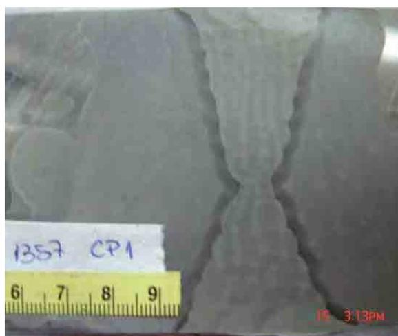
Figura 3.13 – Macrografia na junta soldada para definição da região da ZTA, ataque com Nital 2%.
