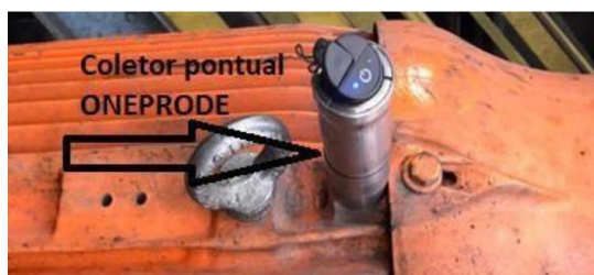
Figura 36 - Acelerômetro do tipo pontual ONEPRODE FALCON
