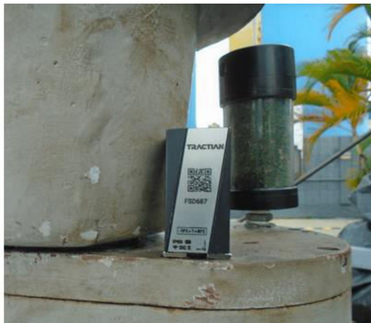
Figura 44 - Smart Trac instalado em um ativo
