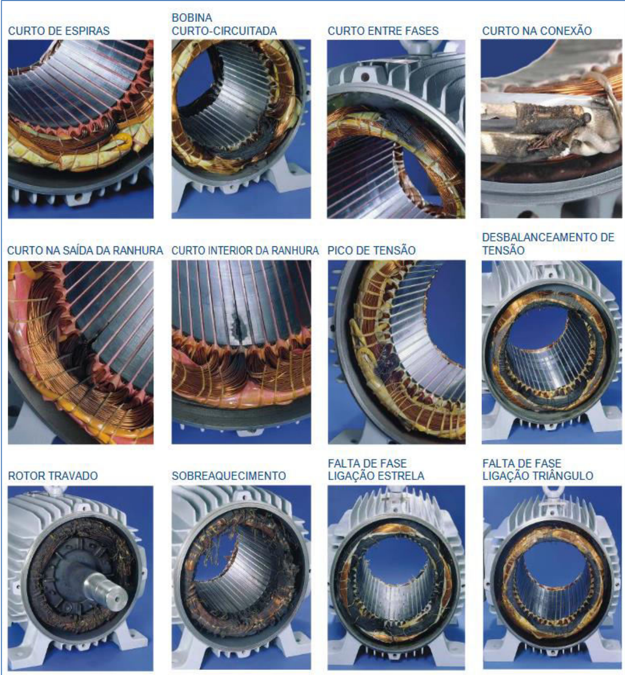
Figura 12 - Principais falhas referentes ao enrolamento do MIT
