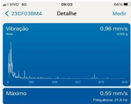
Figura 40 - Análise de frequência e vibração do ativo
