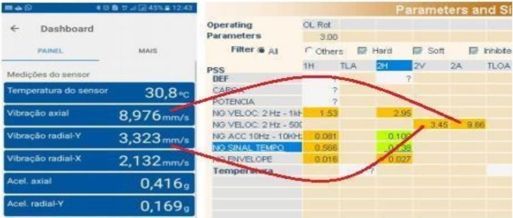
Figura 41 - Comparativo de dados coletados dos dois dispositivos
