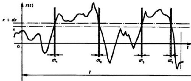
Figura 6.8: Cálculo da função densidade de probabilidade p ( x ) para um processo aleatório.
