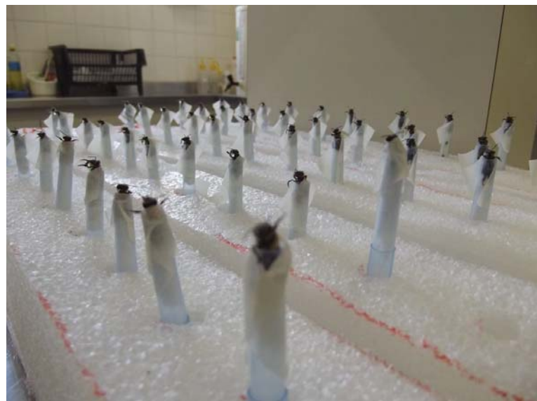
Figura 3: Conjunto de abelhas para realização do teste de reflexo de extensão da probóscide para recém-emergidas.
