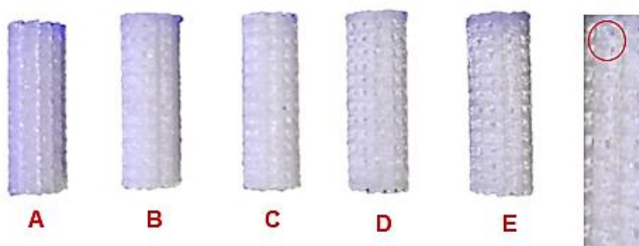
Figura 28 - Geometria RoundBar+Cube: A – Scaffold não recoberto, B – Recobrimento com 0,5% de PCL e 1 camada, C - Recobrimento com 0,5% de PCL e 2 camadas, D – Recobrimento com 1% de PCL e 1 camada, E – Recobrimento com 1% de PCL e 2 camadas, em destaque presença de PCL aderido ao scaffold. Fonte: dados do autor.
