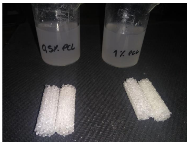
Figura 17 - Preparação dos scaffolds para recobrimento. Fonte: dados do autor.
