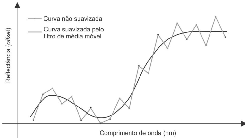
Figura 14 - Resposta espectral original, não suavizada, e suavizada pelo filtro de média móvel.
