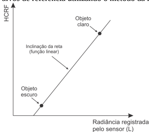
Figura 32 - Predição da equação de transformação dos valores da imagem para valores de HCRF a partir de dois alvos de referência utilizando o método da linha empírica.
