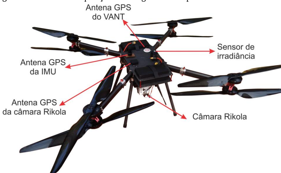
Figura 29 - Sistema de aquisição das imagens multiespectrais com a câmara Rikola.
