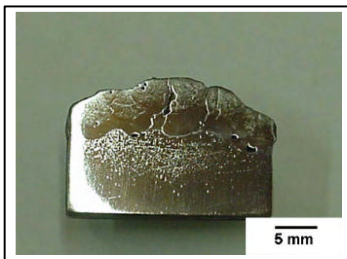
Figura 4.14: Corpo de prova 100D, soldado com 100 amperes com depósito de duas camadas.
