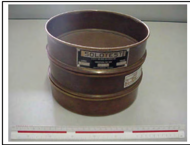
Figura 3.3 – Sistema de peneiras, empregado na conferência da granulação da areia.
