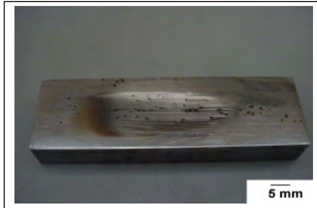
Figura 4.15 - Amostra revestida com uma camada com corrente de soldagem de 180 A, após ter sido desgastada. Corpo de prova 180A.
