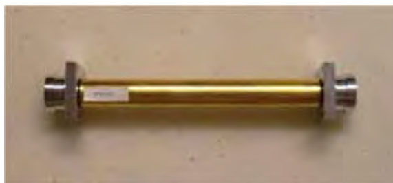
Figura 11: Caminho óptico do analisador LI-840.
