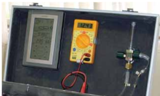
Figura 24: Vista do painel superior da maleta do analisador, constando da esquerda para direita de sensor Termo Hígro, multímetro e rotâmetro.
