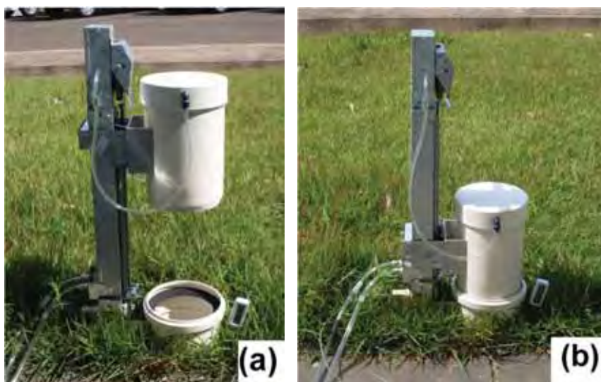
Figura 35: Câmara automática em uso. (a) completamente aberta e (b) completamente fechada.
