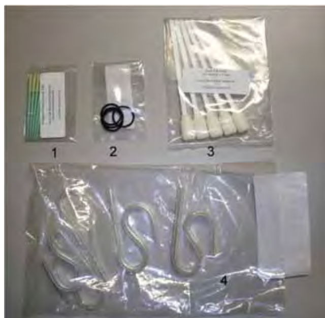
Figura 15: Kit de limpeza que acompanha o analisador Licor LI-840. 1-Cotonete para limpeza da fonte de infravermelho e do detector, 2- Anéis de borracha de reposição, 3- Cotonetes para limpeza do caminho óptico, 4- mangueiras internas de reposição.
