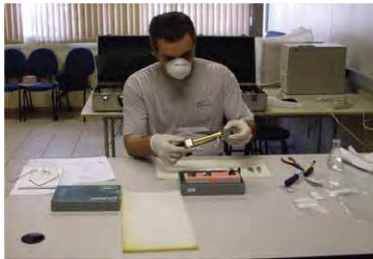
Figura 17: Foto retirada durante o procedimento de limpeza do LI-840.
