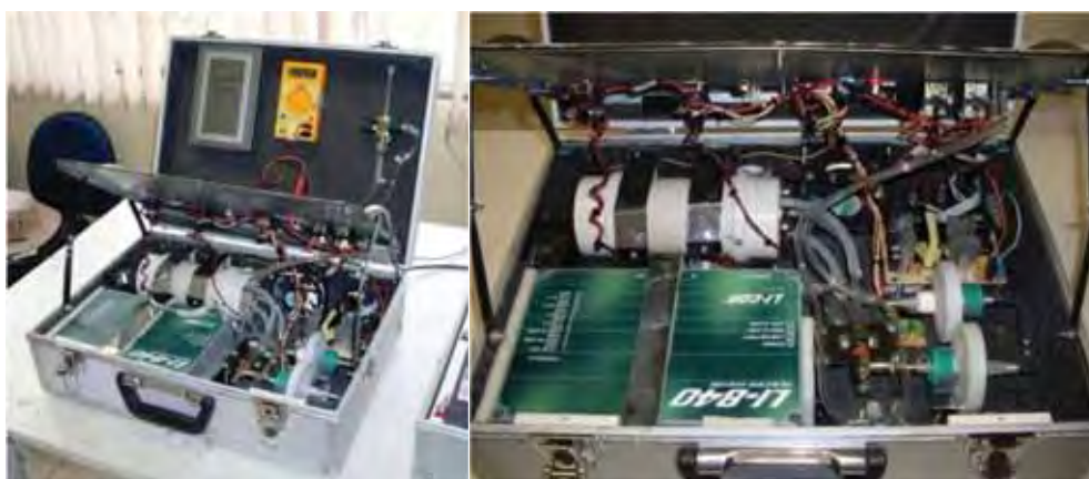
Figura 21: Montagem do LI-840 na maleta do analisador.
