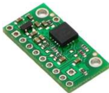
Figura 42 - Conjunto com o giroscópio modelo LPR510AL.
