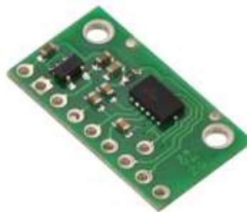
Figura 44 - Conjunto com o acelerômetro modelo MMA7341L.
