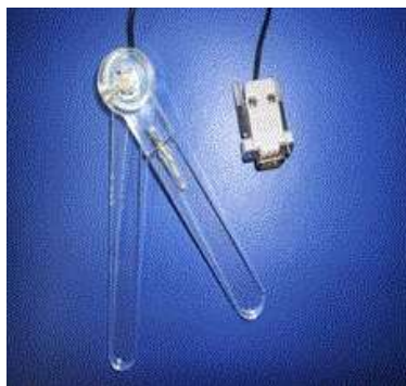
Figura 39 - Eletrogoniômetro resistivo utilizado.
