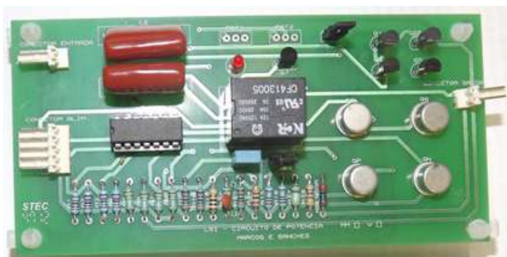
Figura 56 - Foto do circuito de um canal do eletroestimulador.
