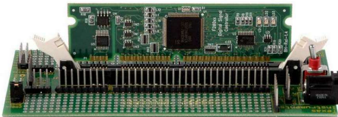
Figura 66 - Estação de trabalho Experimenter Kit USB DockingStation.
