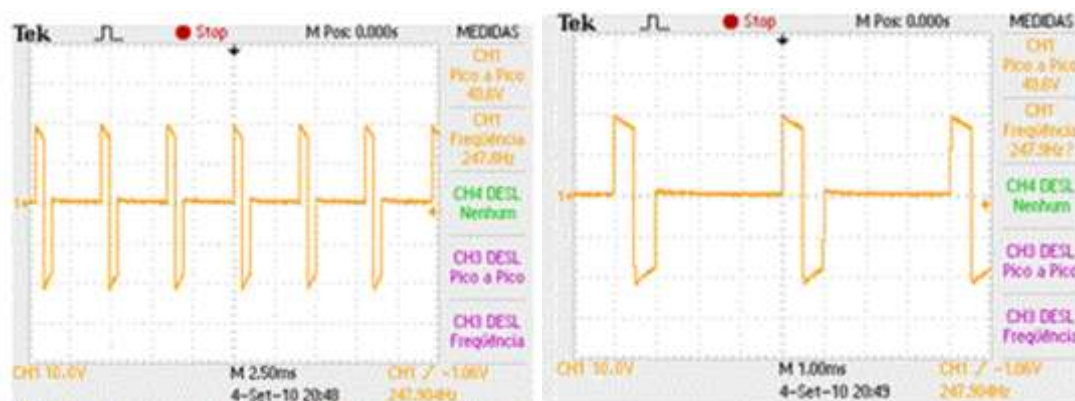
Figura 64 - Sinais utilizando o eletroestimulador comercial Neurodyn II.
