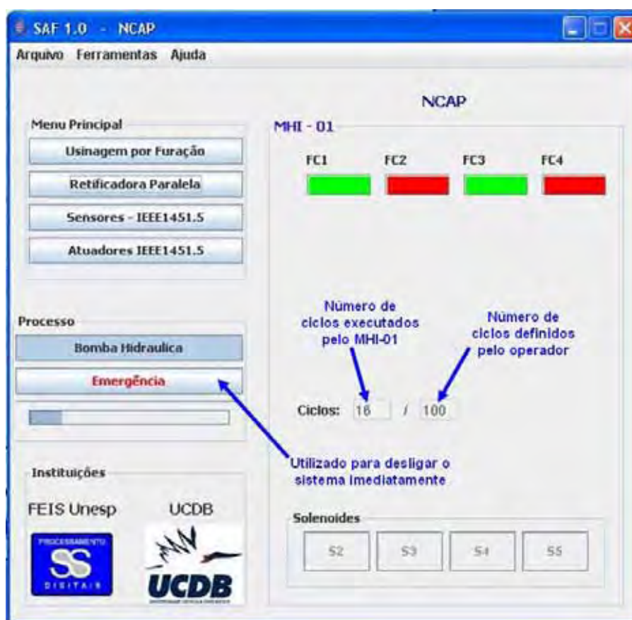
Figura 5.51: Interface gráfica do SAF utilizada na automação do MHI-01 .
