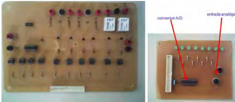
Figura 15D: Placas de circuito impresso para automação da Casa de Vegetação.
