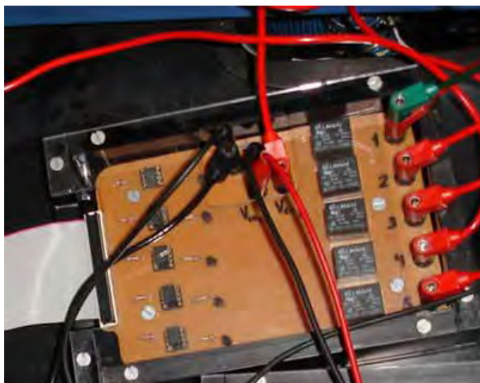
Figura 3D: Circuitos eletrônicos utilizados para os atuadores do MHI-01 protegidos por caixa de acrílico.
