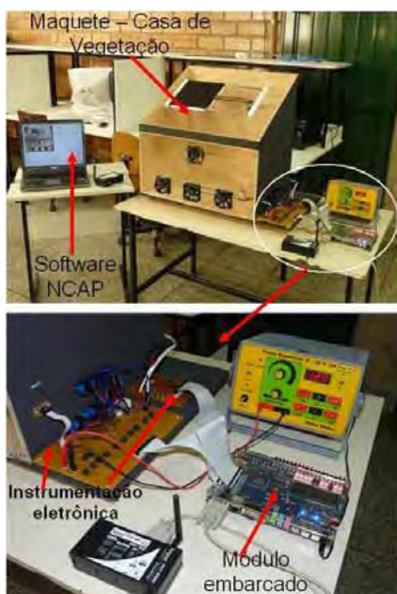
Figura 17D: Automação de uma Maquete Casa de Vegetação.
