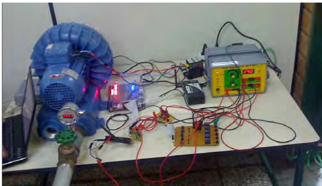
Figura 13D: Configuração utilizada para testar a automação sem fio do processo de Filtragem do Biogás.
