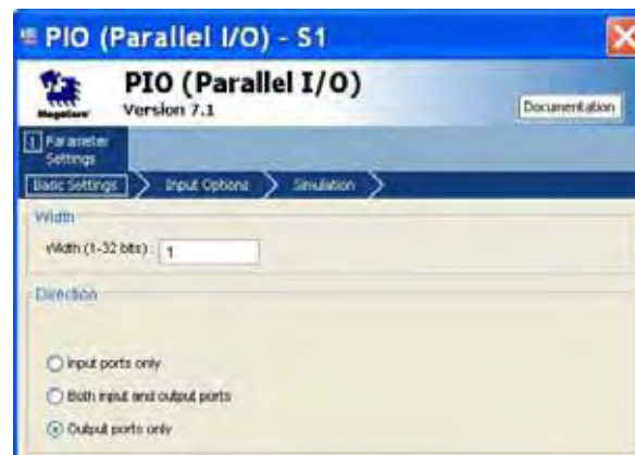
Figura 4.29: Dispositivo de saída configurado para compor o DriverMMI .
