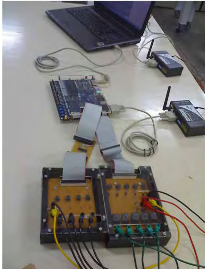
Figura 5D: Configuração para automação sem fio utilizando a tecnologia Wi-Fi .
