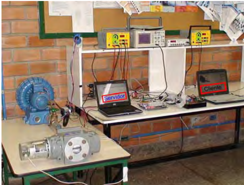
Figura 9D: Instrumentação de auxílio para viabilizar parte da automação do processo de Filtragem de Biogás.
