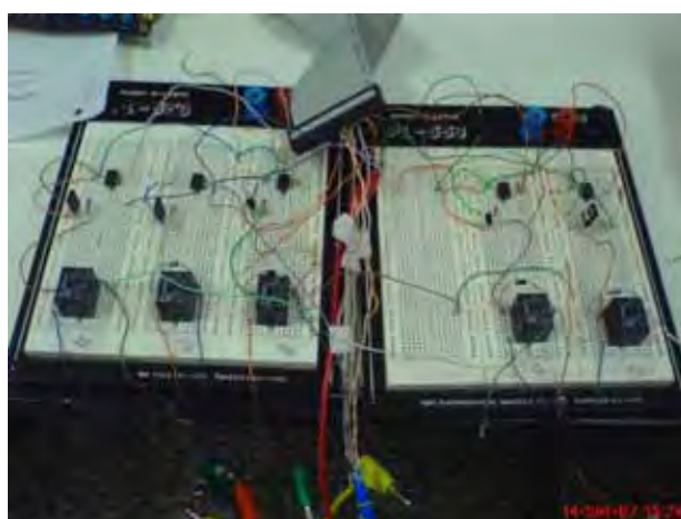
Figura 1D: Circuitos eletrônicos utilizados para os atuadores do MHI-01 implementados em protoboard .
