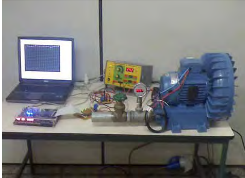
Figura 11D: Medição da pressão via NCAP (gráfico) e através do transmissor de pressão.
