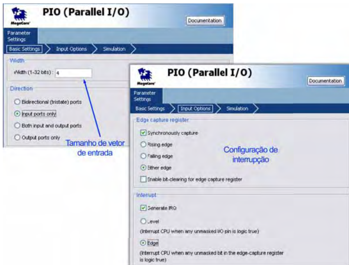
Figura 4.30: Configuração dos dispositivos de entrada do DriverMMI .
