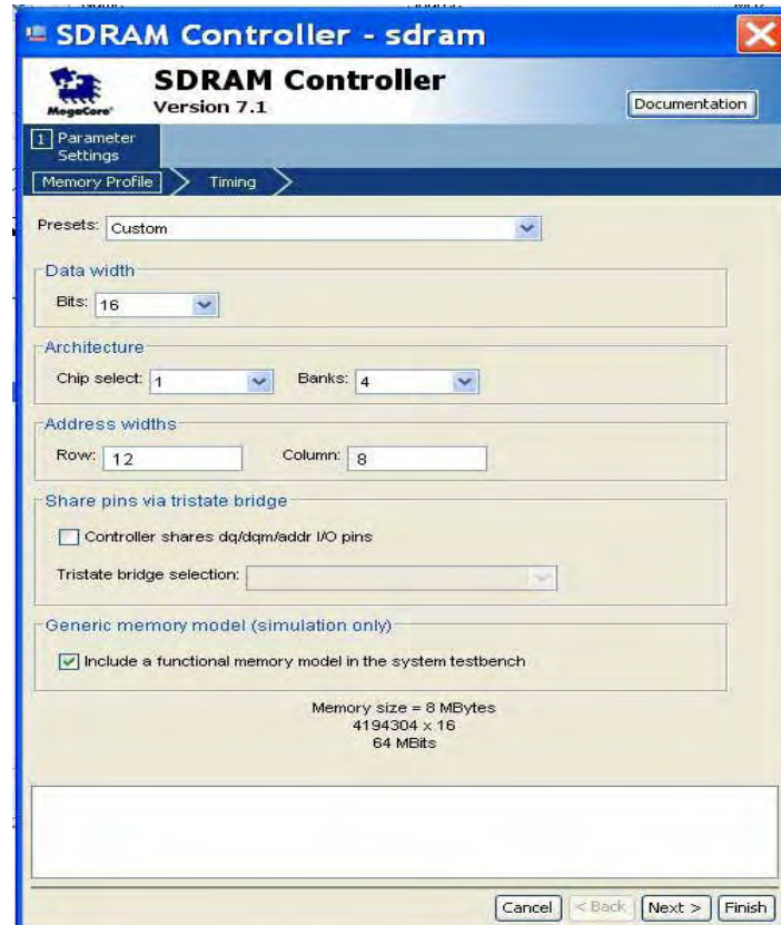
Figura 4.24: Configuração da memória SDRAM , do DriverMMI .
