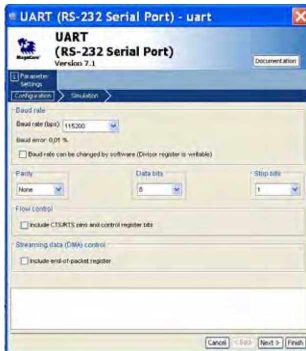
Figura 5C: Configuração da UART RS232 no SOPC Builder .
