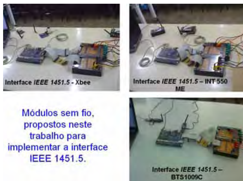
Figura 5.73: Módulos utilizados para implementar a interface IEEE 1451.5 .
