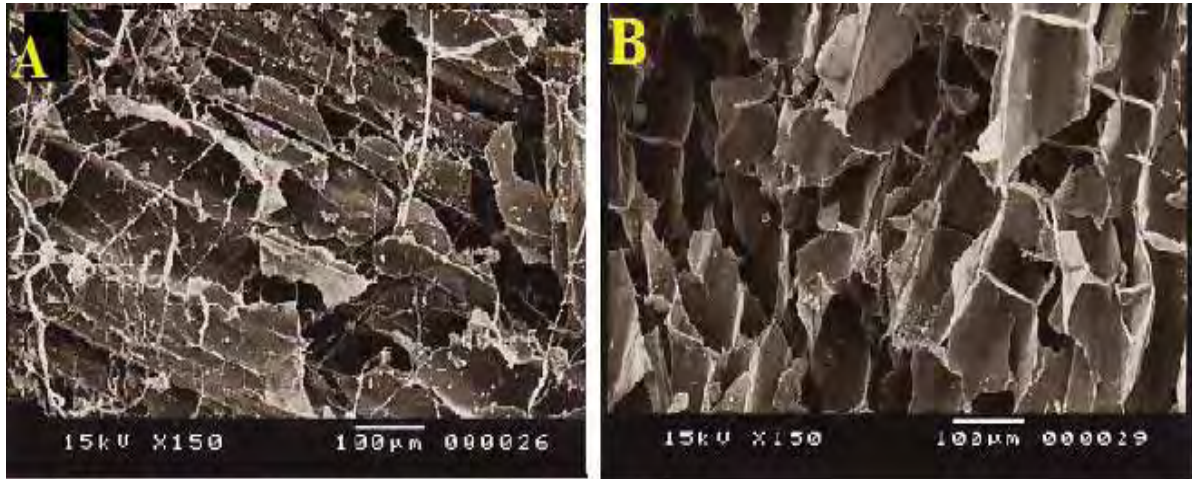
Figura 12. Elétron-micrografias de varredura da parede celular cana-de-açúcar após 3 horas de aplicação da cal em suspensão com tamanho de partículas de 4 mm (A) e 10 mm (B).
