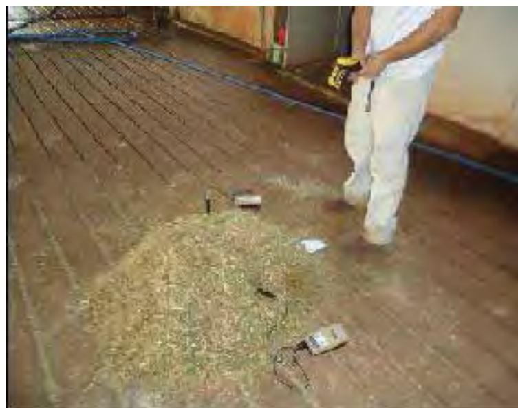
Figura 4. Obtenção das temperaturas com termômetro infravermelho e com haste metálica.
