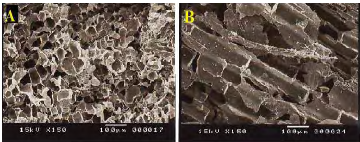
Figura 11. Elétron-micrografias de varredura da parede celular cana-de-açúcar após 3 horas de aplicação da cal em pó com tamanho de partículas de 4 mm (A) e 10 mm (B).
