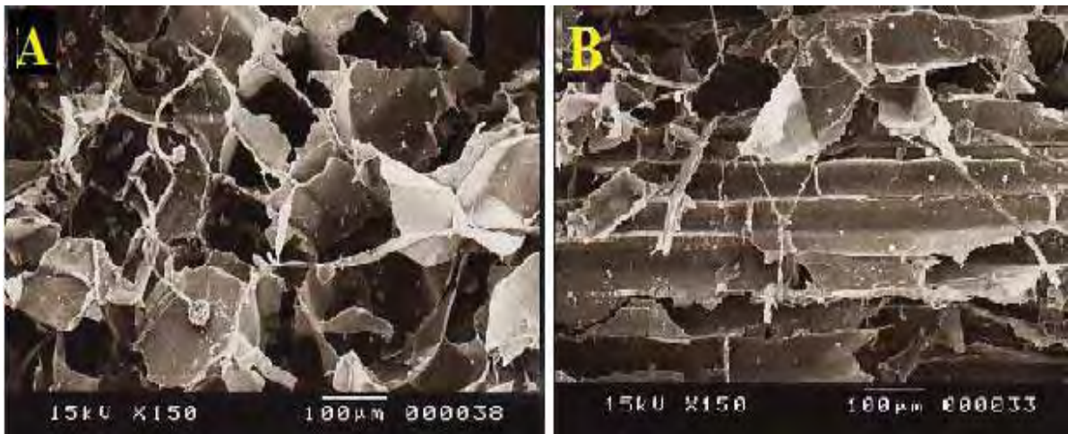
Figura 13. Elétron-micrografias de varredura da parede celular cana-de-açúcar após 6 horas de aplicação da cal em pó com tamanho de partículas de 4 mm (A) e 10 mm (B).
