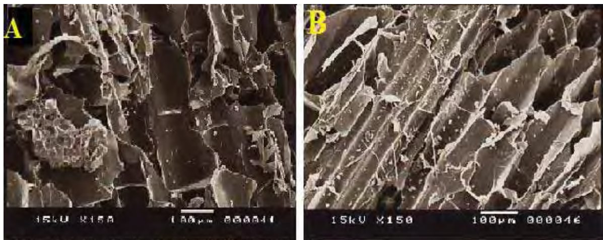
Figura 14. Elétron-micrografias de varredura da parede celular cana-de-açúcar após 6 horas de aplicação da cal em suspensão com tamanho de partículas de 4 mm (A) e 10 mm (B).
