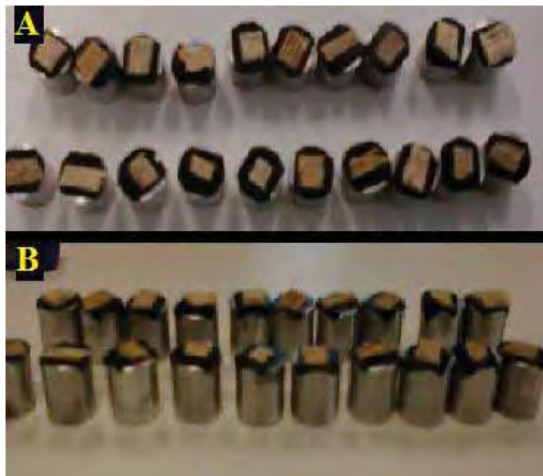
Figura 6. Vista superior (A) e lateral (B) das amostras secas fixadas aos stubs com fita de carbono.
